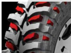
**EL BLOQUE SECUNDARIO DE LA BANDA DE RODADURA** ayuda a eliminar fácilmente el lodo y el limo.
