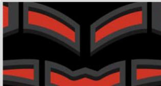
**LOS BLOQUES DE BANDA DE** rodadura contorneados aumentan la tracción al conducir por terrenos extremos como tierra, arena y nieve.
