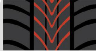
**LA COMBINACIÓN DE SURCOS EN FORMA DE V Y PRINCIPALES** proporcionan un drenaje eficiente del agua para evitar el riesgo de aquaplaning.
