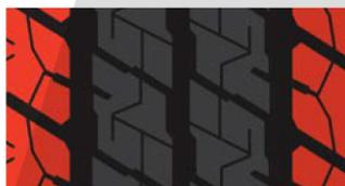
**BLOQUES LATERALES FUERTES** Proporciona un buen trazado en las curvas para evitar el subviraje o el sobreviraje.
