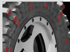
**EL FLANCO AGRESIVO** proporciona una tracción lateral optimizada en terrenos extremos.
